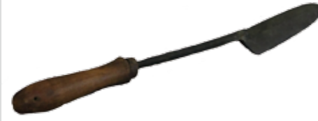
▶炭火で直接熱して使う火ゴテ
