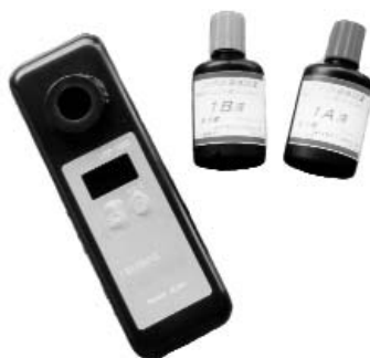
▼ 水道水の中に含まれている塩素の濃度を測る器具
